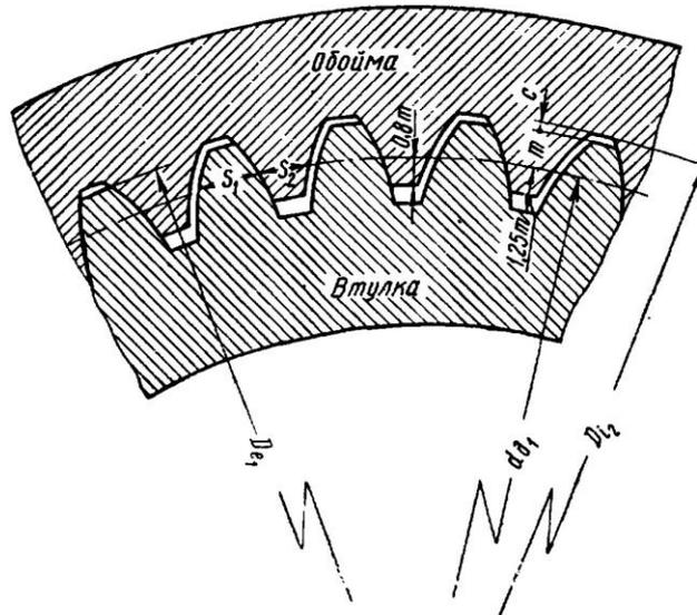
Черт. 5.  $2c$ —гарантированный зазор между центрирующими диаметрами  $D_{i2}$  и  $D_{e1}$
